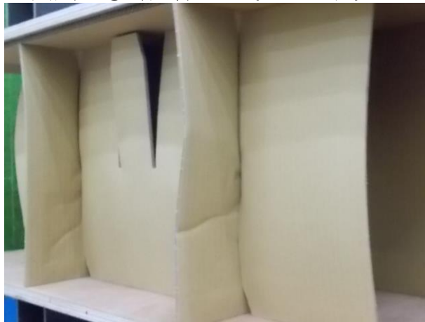
試験結果 ② 最大荷重時の状態 座屈状態
