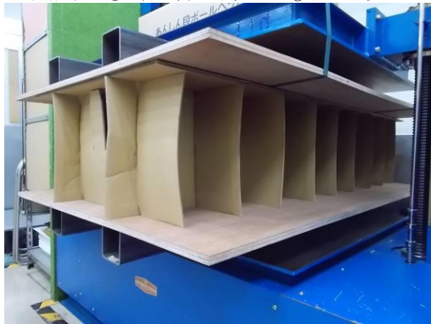
試験結果 ② 最大荷重(3,252 kgf)時の状態
