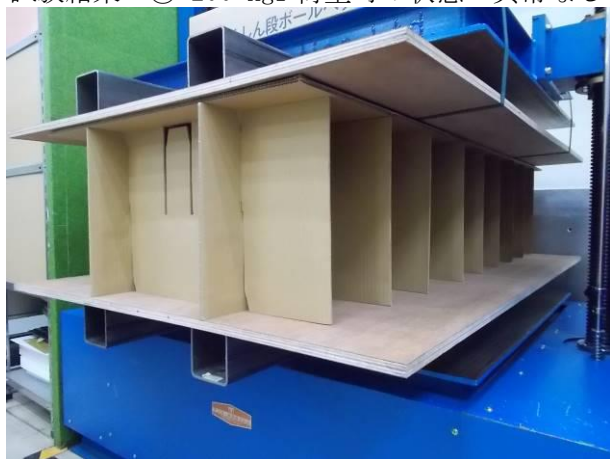
試験結果 ② 最大荷重(3,252 kgf)時の状態
