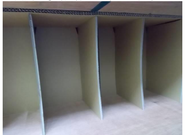
試験結果 ② 最大荷重時の状態 湾曲状態
