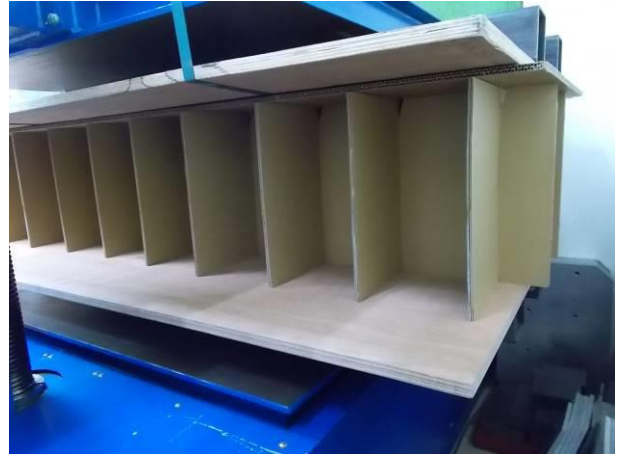
試験結果 ② 最大荷重時の状態 湾曲状態
