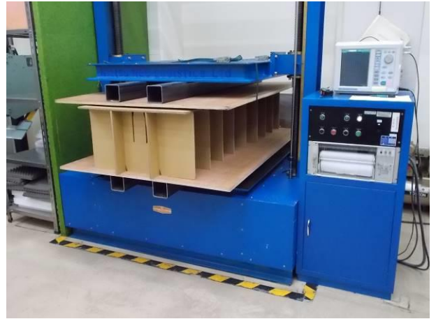
試験結果 ① 200 kgf 荷重時の状態 異常なし
