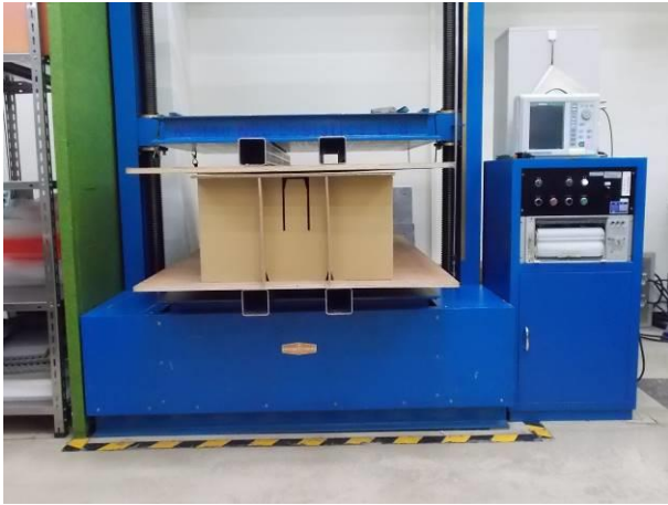
試験結果 ① 200 kgf 荷重時の状態 異常なし
